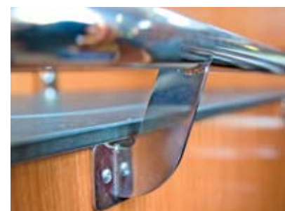
Verbesserungspotenzial: eingerissene Fuge am Hauptschott und rechtscharfkantige Winkel am Handlauf der Pantry.
