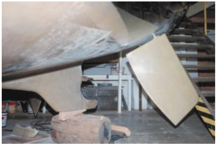
Die Blätter der Doppelruderanlage haben keine lange Anströmkante. Dennoch arbeiten sie effektiv.
