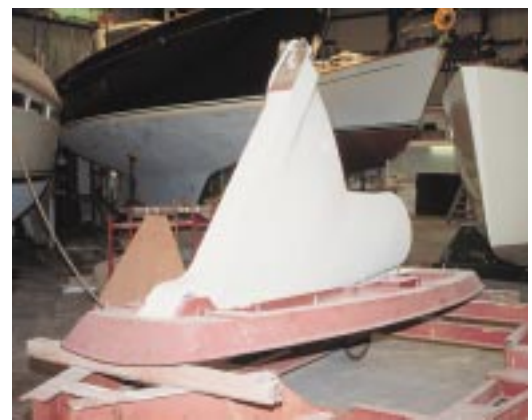
Der Schwenkkiel und seine solide gusseiserne Grundplatte geben dem Schiff mehr als drei Tonnen Ballast.
