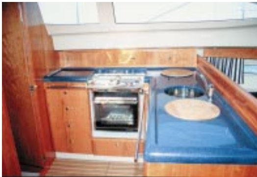
Die Pantry bietet viel Arbeitsfläche. Das längslaufende Söhl sollte allerdings höher sein.
