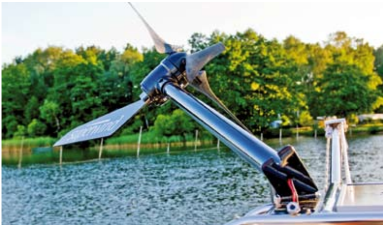
Für niedrige Brückendurchfahrten lassen sich auch die Windgeneratoren seitlich abklappen.
