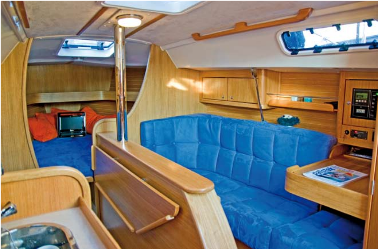
Unter Deck wartet die Arion 29 mit einem vollwertigen Tourenyacht-Interieur auf, das zudem durchdacht gestaltet wurde. Zahlreiche zu öffnende Luken lassen viel Licht und bei Bedarf auch Luft ins Innere. Schön gelöst: Das vordere Halbschott, das den Raum optisch vergrößert und zugleich dennoch eine gewisse Abgeschlossenheit der Vorschiffskammer vermittelt.
