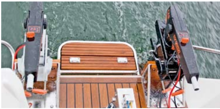
Die beiden Elektromotoren der Testyacht nehmen einen Teil der ansonsten vergleichsweise großzügigen teakbelegten Badeplattform ein – der Eigner hat daher eine kleine Fläche „angebaut“.
