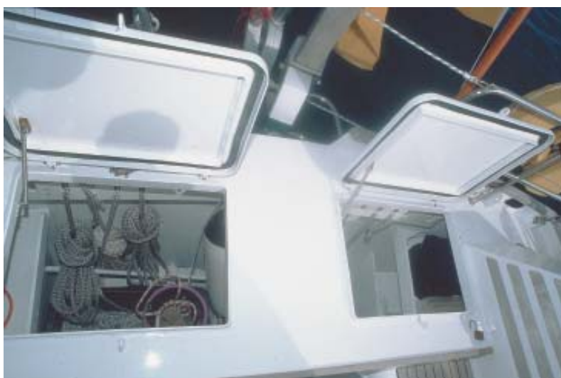
An Steuerbord sind große Backkisten eingebaut
