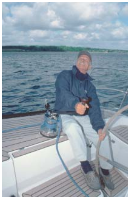
Der Rudergänger kann die Großschot an beiden Seiten des Cockpits mit je einer Winsch holen
