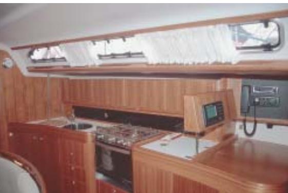
Die Pantry der Modern Version ist vorbildlich mit Handläufen bestückt; die Spüle ist dagegen ungünstig weit vorn installiert
