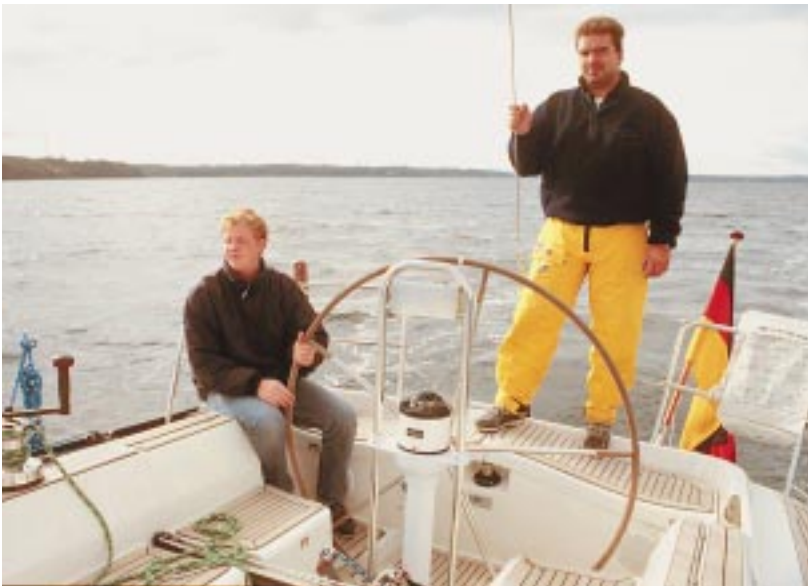
Das große Steuerrad ist sehr direkt übersetzt. Man kann bequem von Luv, von Lee und von mittschiffs aus steuern.
