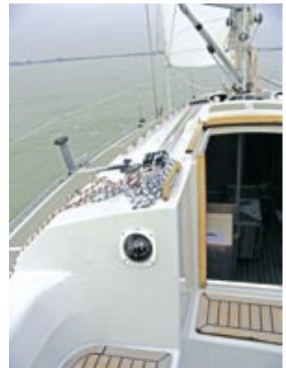
Als Extra werden die Fallen nach achtern umgelenkt angeboten
