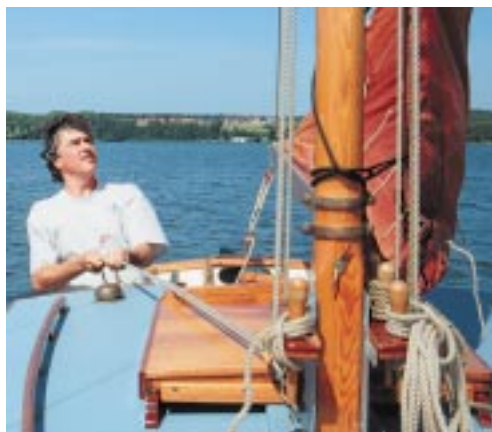
Das Großsegel setzt man mit Hilfe von Piek- und Klaufall.
