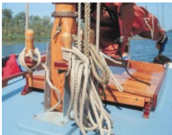
Eine traditionelle Nagelbank dient zum Belegen der Vor- und Toppsegelfallen.
