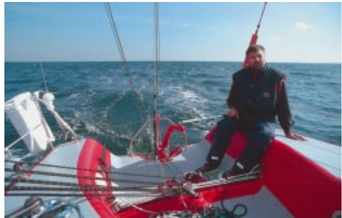
Auch in schneller Fahrt manövriert der Steuermann das Boot entspannt und sicher. Ist nur eine kleine Crew an Bord, kann er von seiner Position aus auch Großschot und Traveller bedienen.
