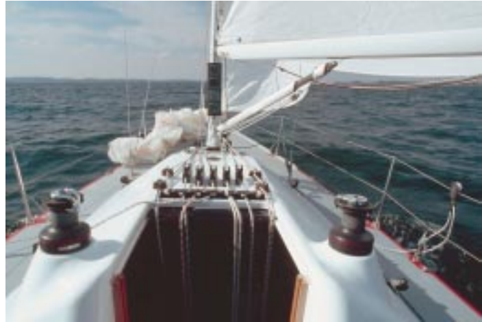
Alle Schoten und Strecker können von einem Mann bedient werden, der bequem im Niedergang steht.
