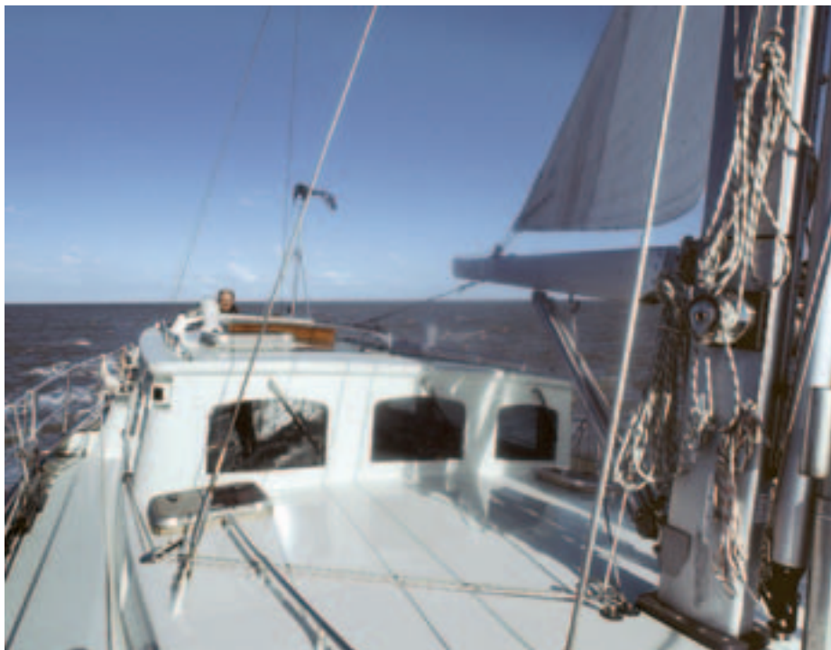
Die aufgeschossenem Fallen am Mast müssen in der Regel nicht angerührt werden
