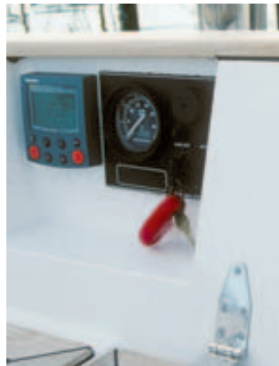
Das versenkt eingebaute Motorpanel ist im Cockpit nicht im Weg
