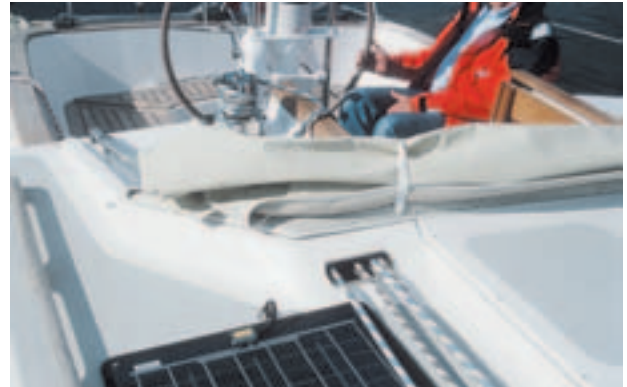
Die Fallen laufen durch das Süll auf die Winschen
