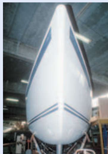
Die Schalen werden in Balsasandwich gebaut, von der Wasserlinie nach unten massiv. Die Holzarbeiten sind von hoher Qualität und in Mahagoni, Kirsche oder Teak möglich
