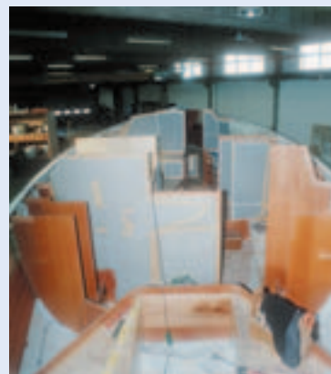
Die Schalen werden in Balsasandwich gebaut, von der Wasserlinie nach unten massiv. Die Holzarbeiten sind von hoher Qualität und in Mahagoni, Kirsche oder Teak möglich
