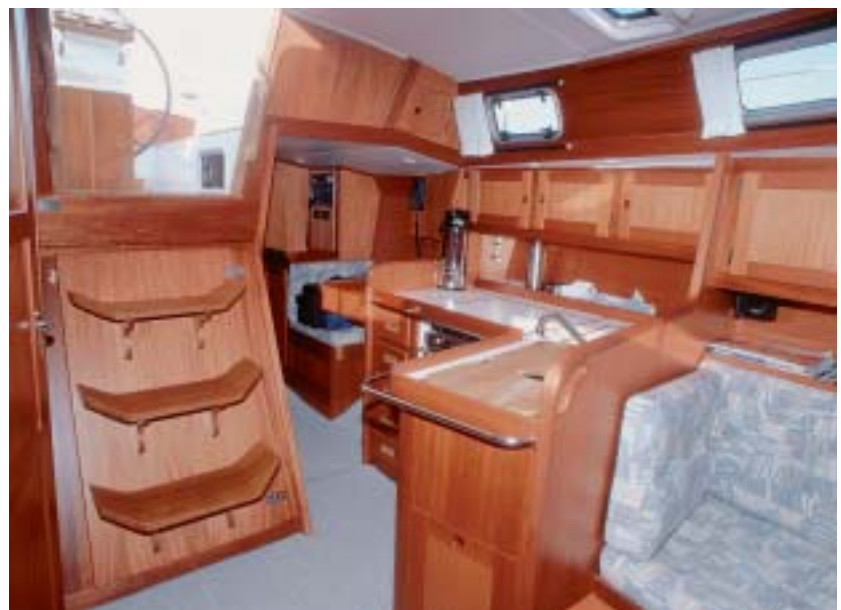
Die Pantry bietet viel Platz und ist durchdacht konzipiert. Der einzige Wermutstropfen: Der Kocher kann nicht weit genug ausschwingen
