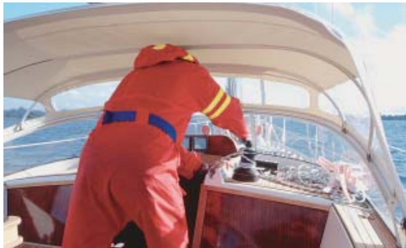
Alle Fallen und Leinen sind nach achtern geführt. Unter der Sprayhood ist viel Platz, um an den Winschen zu arbeiten
