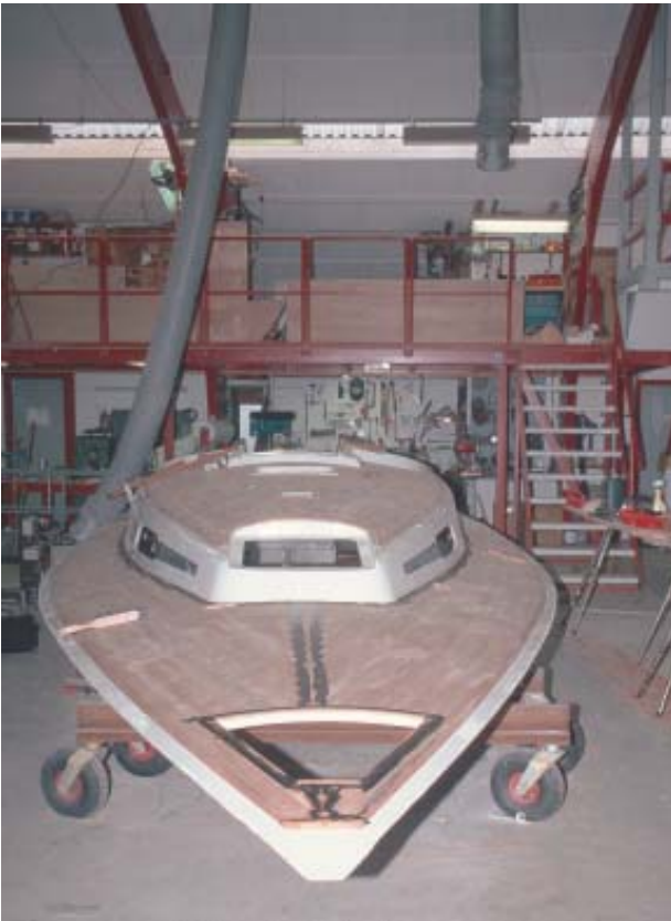
Auf der Werft werden die Decks mit einem Teakstabdeck belegt und ausgerüstet, bevor man sie auf den Rumpf montiert
