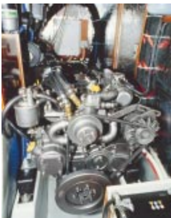
Mit 39 Kilowatt bietet die Maschine eine große Leistungsreserve. ▶
