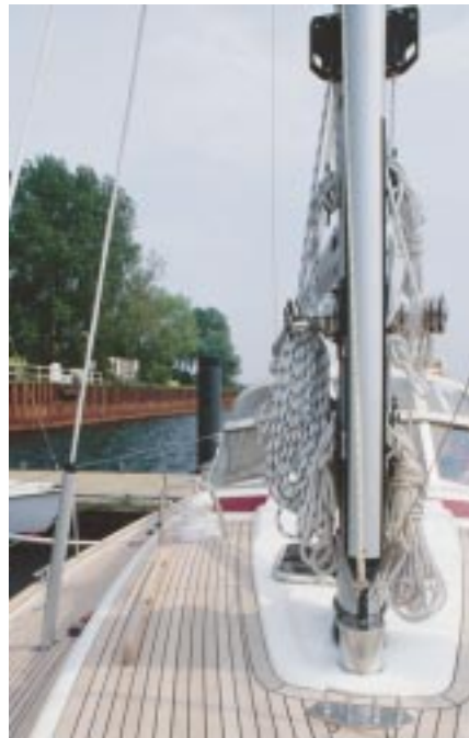
Auf dem Testschiff muss man das Rollgroßsegel vom Mast aus setzen.
