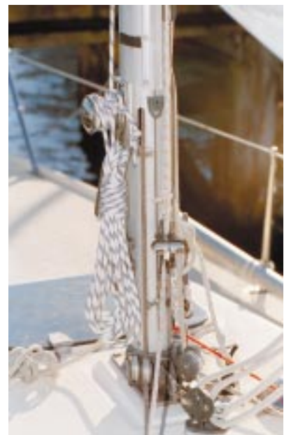
Der auf dem Deckshausdach stehende Mast wird von einem Rahmenspant getragen.
