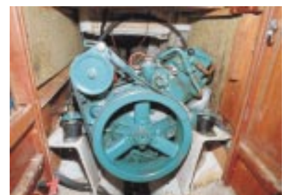
Der Einzylinder-Diesel lässt sich notfalls auch per Hand starten.
