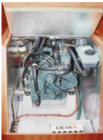
Ein 22 Kilowatt starker Volvo-Diesel treibt das Schiff an.
