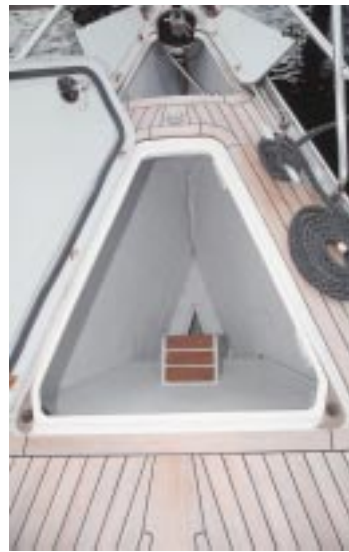
Die Rollanlage ist unter Deck versenkt, dahinter befindet sich abgeschottet die eigentliche Vorkiepe.
