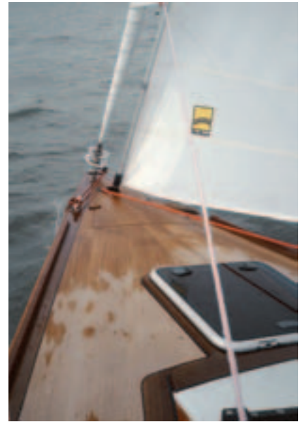
Technische Raffinessen: zwei Stage hintereinander und ein versenkter Fockroller
