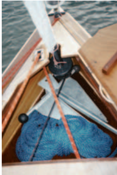
Technische Raffinessen: zwei Stage hintereinander und ein versenkter Fockroller
