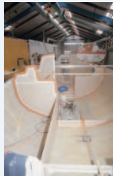
Schotte werden durch solide Winkel-lamine mit dem Rumpf verbunden
