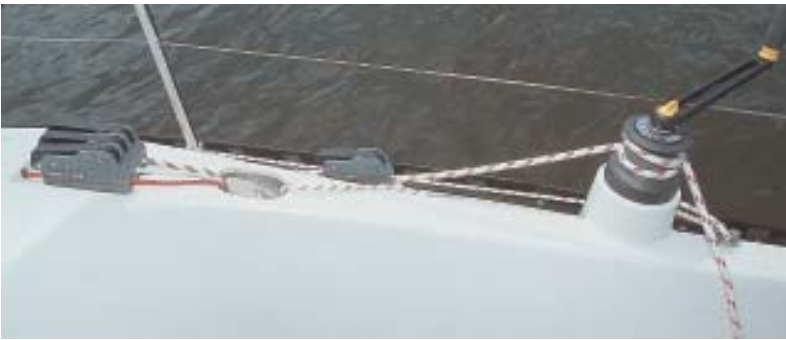
Mit den Cockpitwischen werden Fallen, Strecker und Schoten geholt. Nicht benötigte Leinen verschwinden sauber in einer Tasche, die ins Cockpitsüß eingelassen ist
