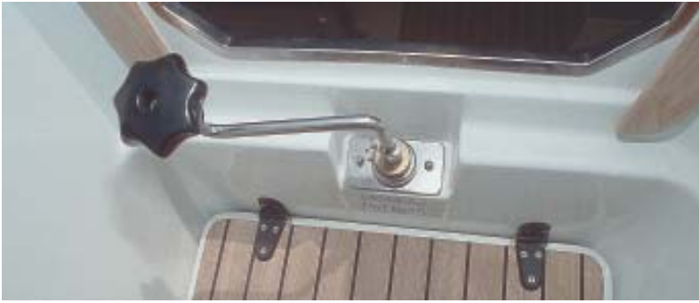
Mit einer kleinen Kurbel wird der Kiel abgesenkt oder aufgeholt
