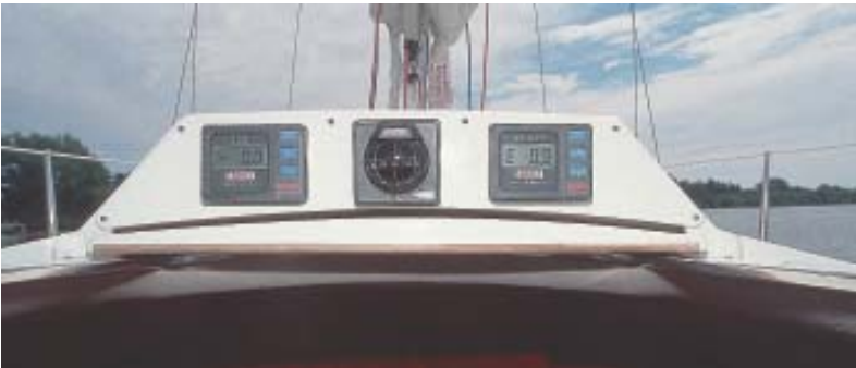
Anzeigeräte sind übersichtlich in eine Instrumentenkonsole über dem Schiebeluk eingelassen
