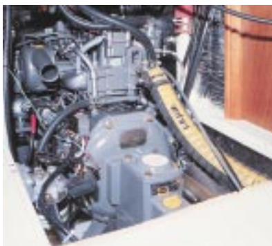
Die Maschine ist von oben aber nicht von der Seite aus zugänglich.
