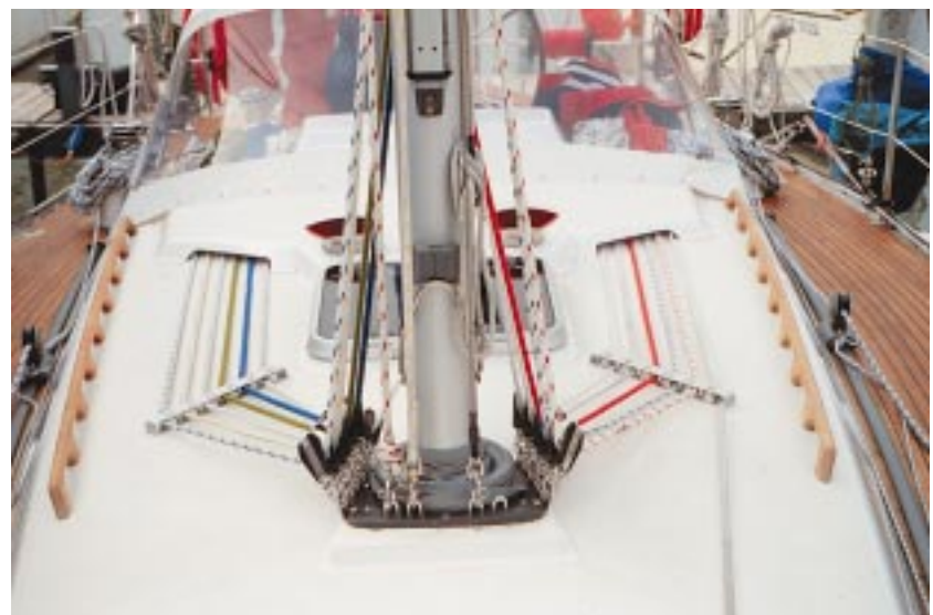
Die Fallen sind teilweise verdeckt nach achtern geführt.
