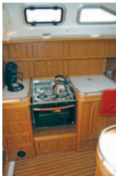
Der Ausbau ist kein Holz, sondern ein Laminat, das die Oberflächen kratzfest und pflegeleicht macht
