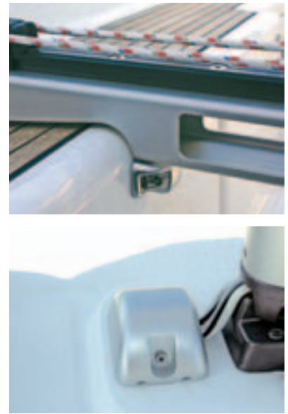
V.l.n.r.: Die Sitzmöglichkeit für den Steuermann ist etwas niedrig ausgefallen Der optionale Traveller im Cockpit ist abnehmbar Die Kabeldurchführung am Mast ist sehr solide ausgeführt
