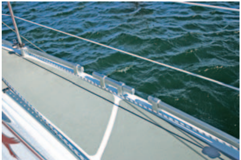
Die für Etap typische Fußreling aus Aluminium mit auf jeder Seite drei ordentlich dimensionierten Klampen
