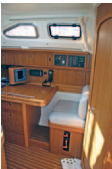
Der Ausbau ist kein Holz, sondern ein Laminat, das die Oberflächen kratzfest und pflegeleicht macht
