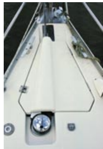
Interessante Details an Deck: Bugbeschlag mit Ring für den Gennakerbaum, Ein-Punkt-Verstägung, gut verankerte Relingsstützen und versenktes Vertikal-Ankerspill
