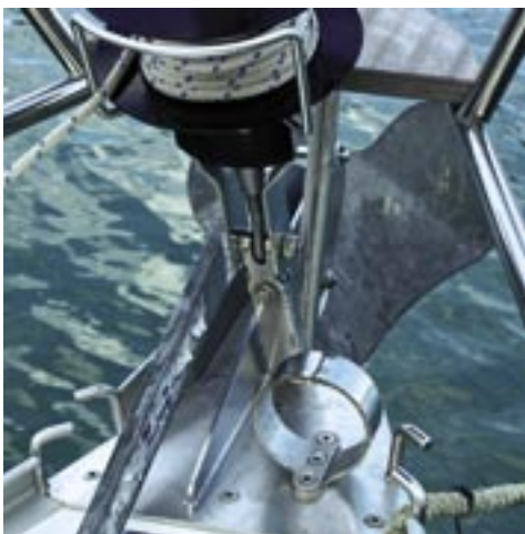
Interessante Details an Deck: Bugbeschlag mit Ring für den Gennakerbaum, Ein-Punkt-Verstägung, gut verankerte Relingsstützen und versenktes Vertikal-Ankerspill
