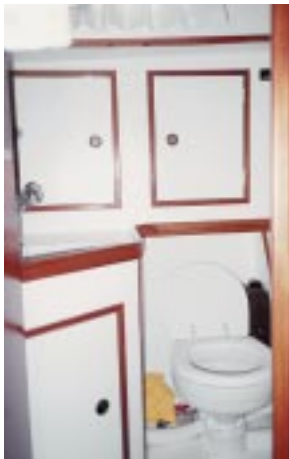
Der achtere Toilettenraum bildet auch den Fluchtweg für die Achterkabine.
