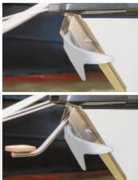
Gut gelöst: Auf den Anker kann man einen kleinen Tritt stecken, der das Besteigen des Bootes vom Steg aus erleichtert.
