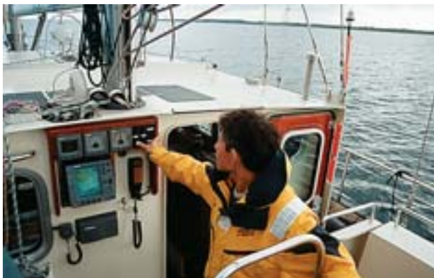
Doppelte Instrumentierung im Ruderhaus und im Cockpit
