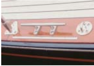
An vielen Stellen findet man durchdachte Details wie diese Klampe mit vorgesetztem Scheuerschutz
