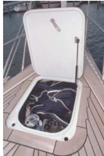
Im Ankerkasten ist platzsparend eine Handwisch für die Ankerkette untergebracht
