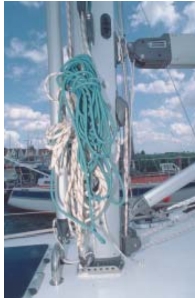
Segelwechsel erfolgen am Mast: Zwei Winschen dienen zum Holen und Durchsetzen der Fallen
