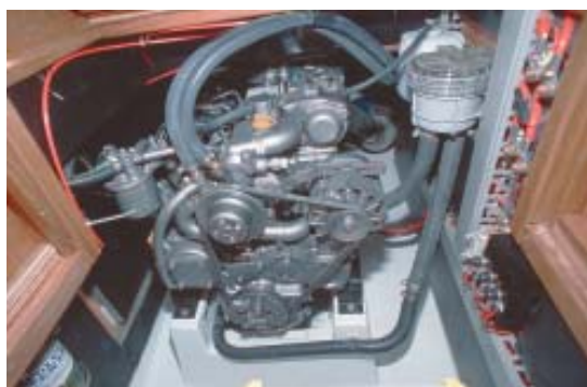
Der 29 Kilowatt leistende Yanmar Dreizylinder bringt das Schiff auch bei Gegenwind voran
