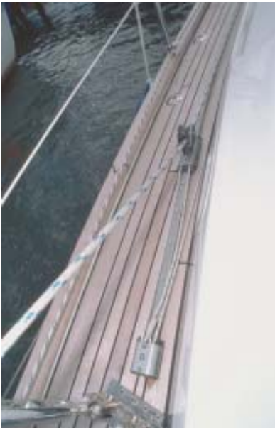
Die Holeyunkte für die Genuaschoten lassen sich auch unter Last vom Cockpit aus verstellen
