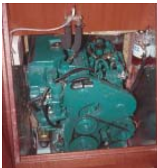
Statt des 35-Kilowatt-Volvo kann auch ein 30-Kilowatt-Yanmar eingebaut werden.
