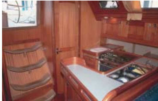
In das Süll der seegerechten Pantry sind Handgriffe eingearbeitet.
