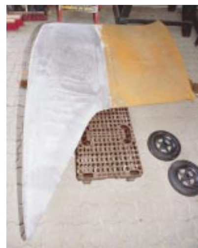
Der neu entwickelte Kiel der Buhl 111 ist zweigeteilt: Er besteht im oberen Teil aus Gusseisen und trägt unten eine große Bleibombe.
